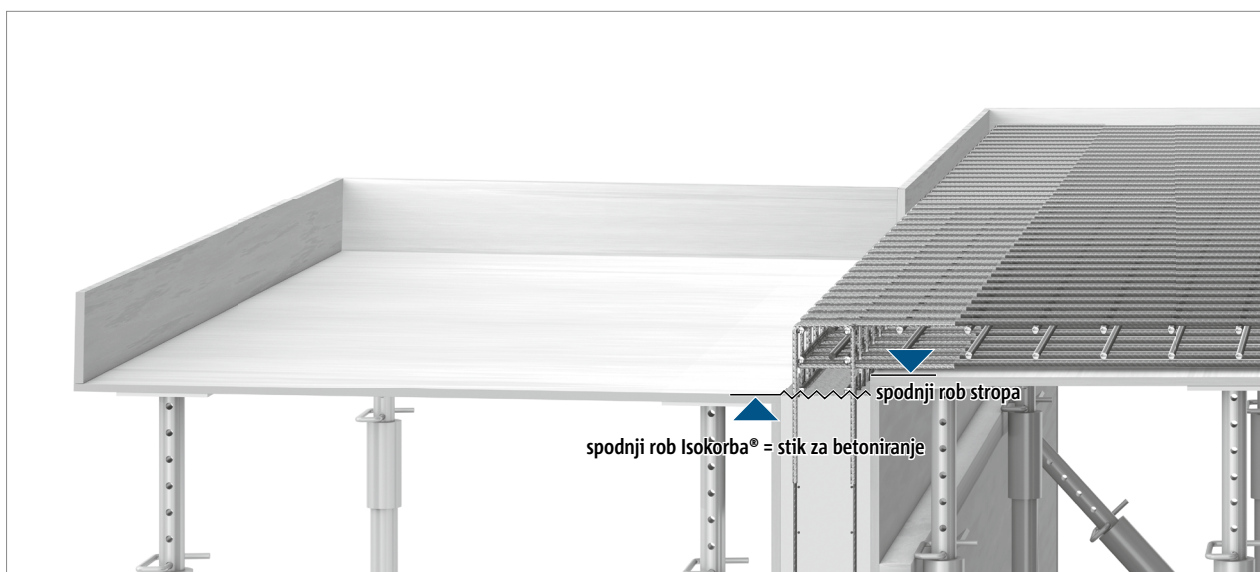
Sl. 39: Schöck Isokorb® T tip KL: priprava opaža in armature za betoniranje. Stik vgrajenega betona na steni = spodnji rob opaža balkona!
