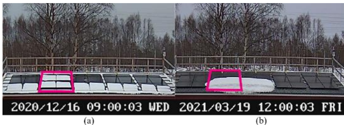
Figur 5: ytbehandlad SoliTek-grupp i rött, vid två tillfällen; (a) tunt lager blöt snö som sannolikt hålls kvar av ramkanterna; (b) snömängd som täcker både ytbehandlad och kontrollgrupp långt in på våren.
