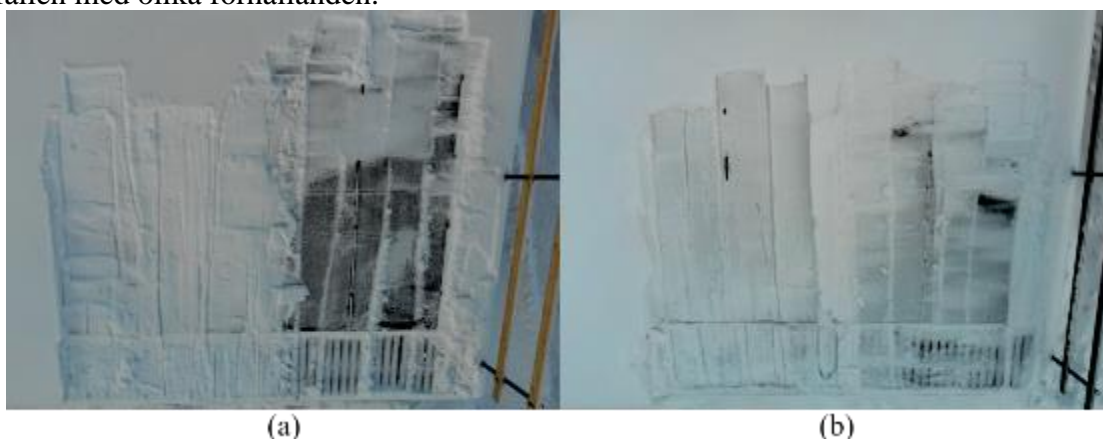
Figur 6: modulgrupper efter mekanisk snöborttagning; (a) 2020-02-07, grov och sockrig snö med skare gjorde att snön vid snöhyvelgruppens topp inte kunde avlägsnas, takrakans grupp blev nästan helt snöfri; (b) 2021-01-25, finkornig, vindpackad och torr snö kunde tas bort effektivt med snöhyvel men fjädringen i teleskopskaftet gjorde det svårt att ta undan den översta snön, takrakan kunde inte ta bort den sista finkorniga snön från modulerna.
