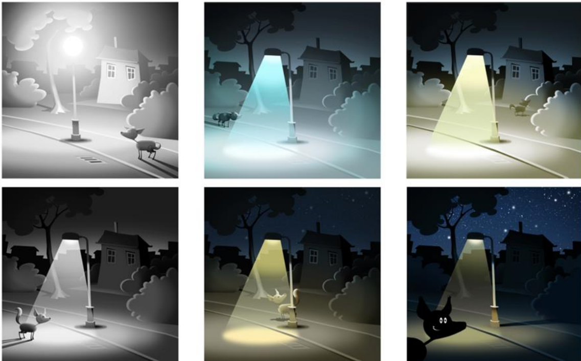
Abbildung 1: Illustration für gute Beleuchtungspraxis der Parameter Abstrahlungsgeometrie, Lichtfarbe und Beleuchtungsstärke in der Straßenbeleuchtung. Illustrationen von Rainer Stock im Auftrag des „Loss of the Night“ Netzwerks LoNNe (EU-COST-Aktion ES1204) © 2016.
